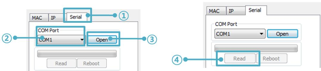
图 3-4 通过串行端口读取参数的顺序
