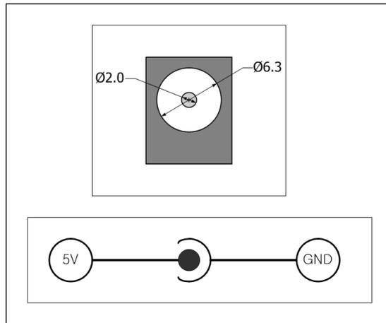
图 1-9 DC 5V 电源 插孔
