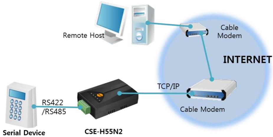
图 1-3 应用在电缆调制解调器的构成
