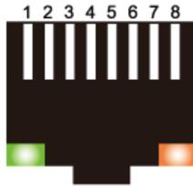
图 1-8 RJ45 以太网连接器规格
